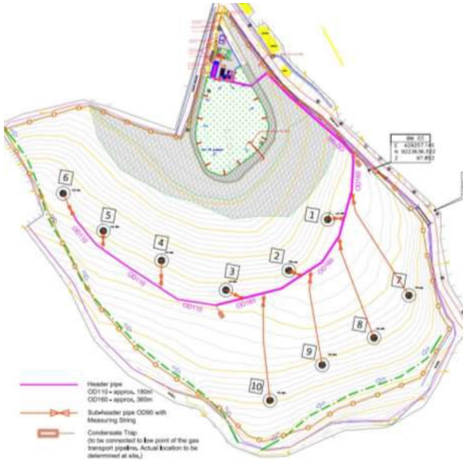
Gambar 3.50 Titik Sumur Landfill Gas
